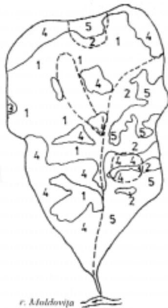
Fig. 3. Cartarea suprafeței bazinului Pușca în funcție de coeficientul de scurgere, pentru o ploaie de 30 mm, textura terenului fiind luto-nisipoasă
