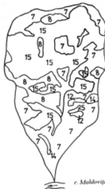
Fig. 2. Retenția (în mm) în bazinul Pușca, pentru o ploaie de 30 mm, textura terenului fiind luto-nisipoasă
