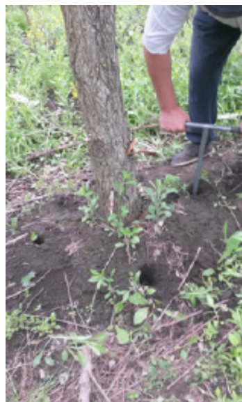
Figura 1 Prelevarea probelor de pe o raza de 1 m Harvesting soil samples from 1 m radius
